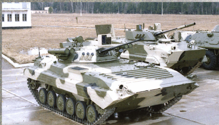
БМП-2 с комплексом вооружения «Бережок», модернизированная тульским КБП.
