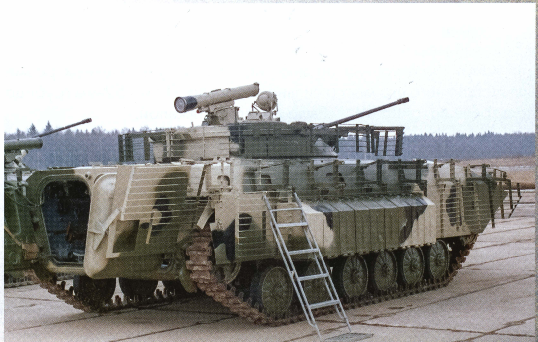
Еще один вариант модернизации БМП-2 ОАО «Курганмашзавод»: машина оснащена противоккумулятивными экранами на корпусе и башне, а также ПТРК «Корнет».
