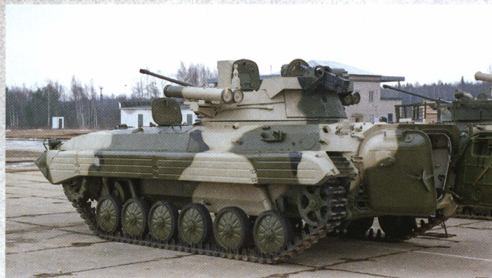
БМП-2, модернизированная тульским КБП, вид сзади. Хорошо видны контейнеры ПТРК и установка автоматического гранатомета на башне.
